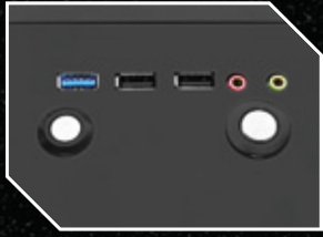
Top-I/O mit 1x USB3.0-, 2x USB2.0-, 2x Audio, Power- und Reset-Knopf
