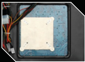
Mainboard-Backplate mit Installationsöffnung für Kühler
