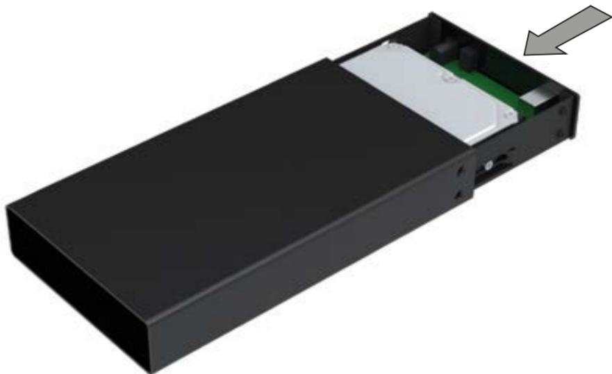
**DE** Schieben Sie den Einschub zurück in das Gehäuse.
